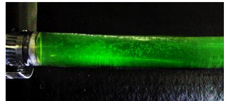
Punto de ebullición del calentador de circulación de refrigerante por termosifón
